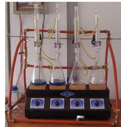
▲晶间腐蚀试验 Intergranular Corrosion
