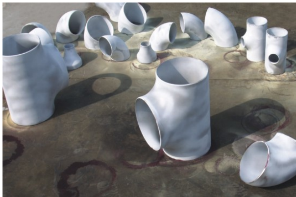
▲渗透试验 Penetration Test
